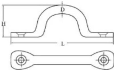
Diese Bugelösen aus rostfreiem Stahl helfen Ihnen, verschiedene Zubehörteile an Ihrem Boot zu befestigen.
