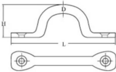
Diese Bügelösen aus rostfreiem Stahl helfen Ihnen, verschiedene Zubehörteile an Ihrem Boot zu befestigen.
