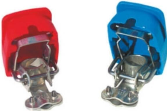
Durch Plastikschutzkappen kein Kurzschlussrisiko. Messing verzinkt, NIRO-Stahl A4, Kappen aus Polypropylen. Für Kabel bis ca. 35 mm<sup>2</sup>, max. 800 A. Gewicht/Paar 170g.
